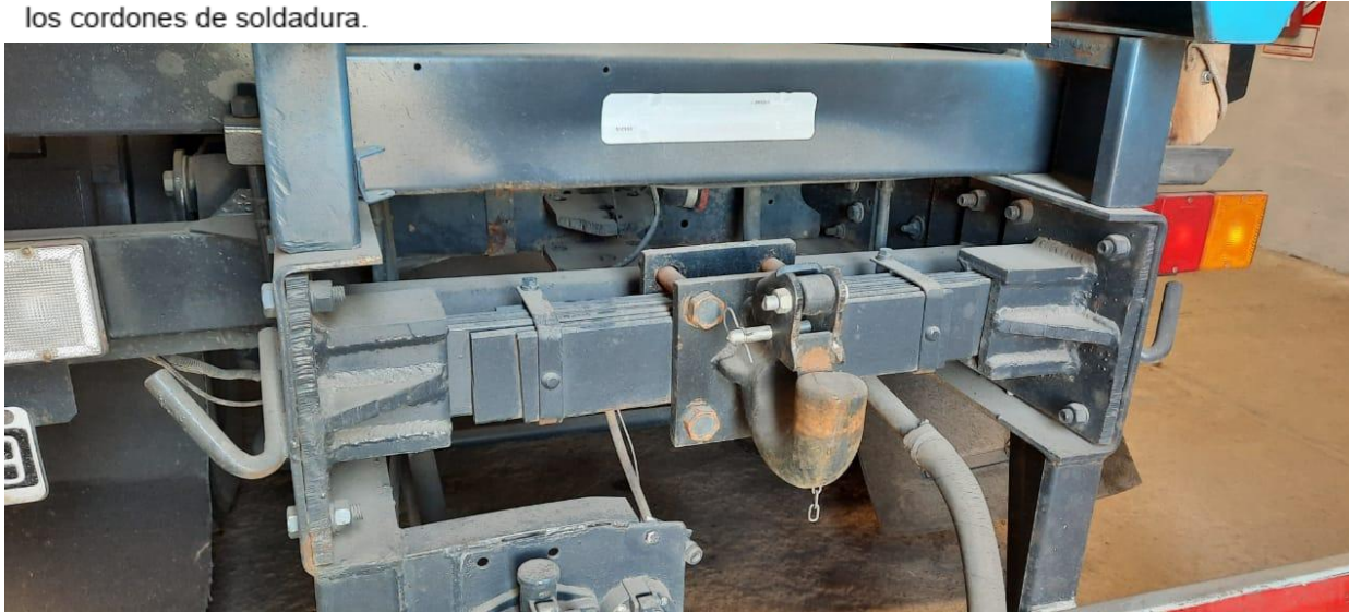
Conjunto: Gancho (IRAM 10259 – Clase K) , Paquete elásticos, Cajas – Sistema no homologado – Gran variedad (fuente: WHEEL - Ing. Luis M. Arrién)
