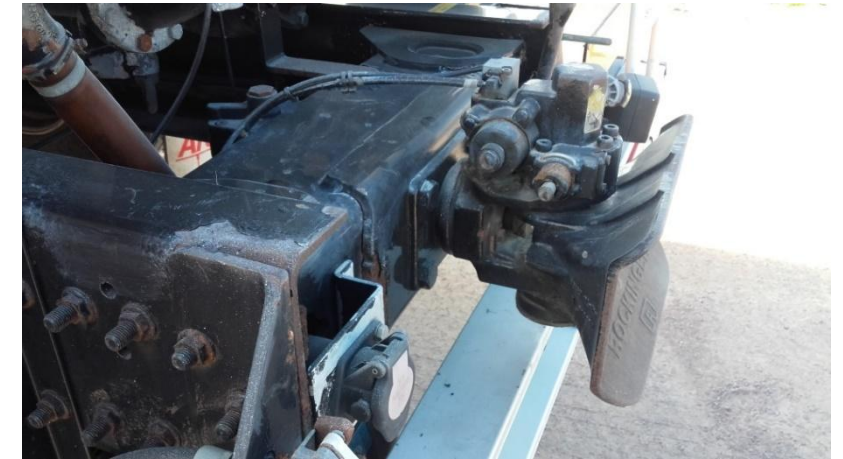
Conjunto: Gancho (IRAM 10259 – Clase K) , Paquete elásticos, Cajas – Sistema no homologado – Gran variedad (fuente: WHEEL - Ing. Luis M. Arrién)
