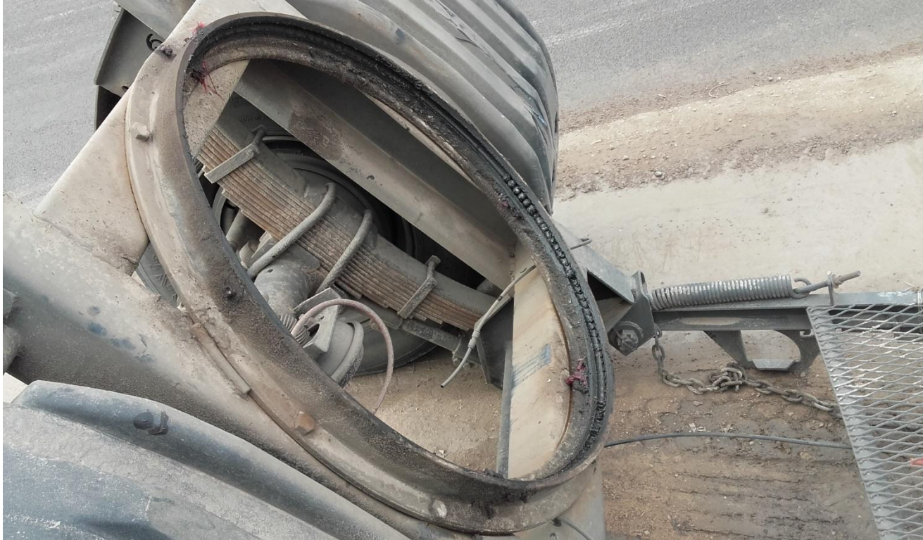
Detalle aro giratorio inferior con bolillas y deformación (fuente: Ing. Luis M. Arrién)
